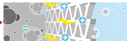
Mikro prachový filtr zachycuje pracové částice a nabíjí je negativními ionty.
